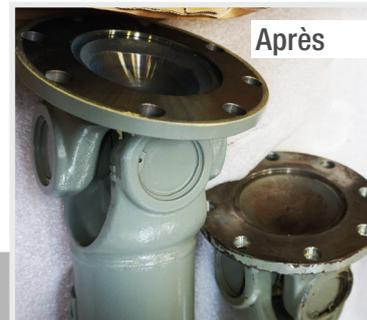
Amortisseur d'un châssis de tramway nettoyé avec notre injecteur de mousse en combinaison avec UNO AV.
